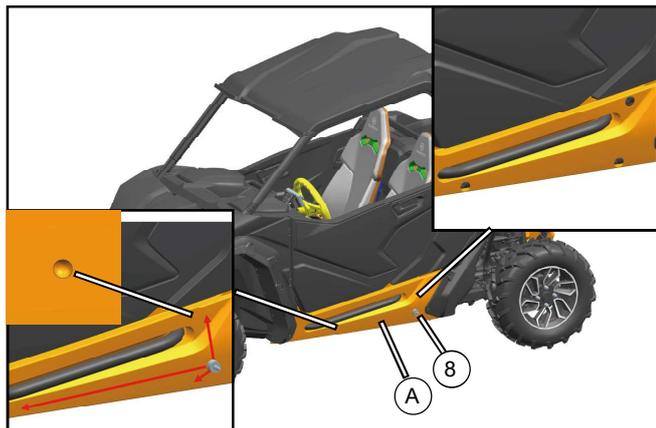
// Utiliser le foret  $\phi$  35 (8) sur une perceuse électrique. Percer un trou aux trois points moulés dans la plaque de protection (A) de chaque côté du véhicule pour exposer les trous filetés sur le cadre.
