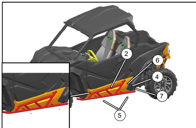
// Placer le pare-choc latéral (2) en position d'assemblage. Installer les boulons (5) aux points de montage inférieurs, ne pas trop serrer pour le moment. Placer la rondelle M8 (6) sur la vis (4) et installer sur le point de montage supérieur. Serrer fermement toutes les fixations latérales du pare-chocs, puis installer le bouchon déco (7) sur la vis (4) du point de montage supérieur.
