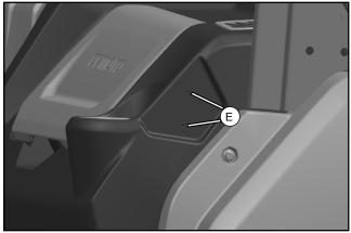
Percez des trous de 10 mm **(E)** sur le côté du tableau de bord avant du panneau selon les marques de trace de trou moulé comme démontré.
