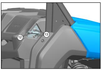
Installez et fixez la plaque de verrouillage droite (12) avec des boulons (13) à l'emplacement du trou percé.
