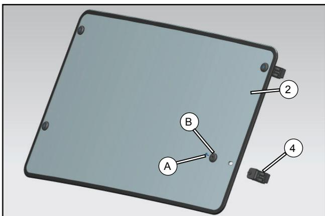
Retirez les joints (B) et les vis (A) des pinces (4), puis installez les pinces (5) sur l'avant du pare-brise (2) avec les joints (B) et les vis (A).
