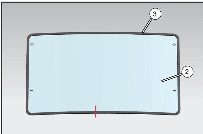
Installez la bande d'étanchéité (3) au pare-brise (2).
