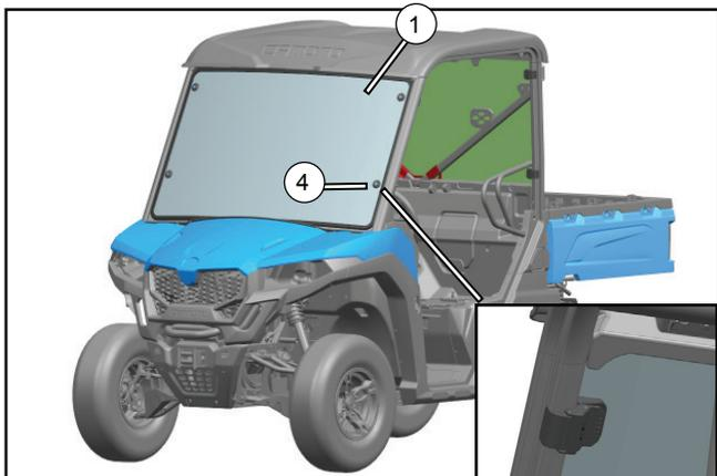
Positionnez l'autre côté du pare-brise avant (1) sur le dessus avant de la barre comme indiqué pour déterminer la position de la pince, puis assemblez chaque côté avec des pinces (4).
