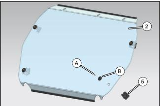
Retirez les joints (B) et les vis (A) des pinces 42 (5), puis installez les pinces 42 (5) sur le pare-brise avant (2) avec les joints (B) et les vis (A).
