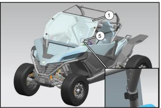
Positionnez l'autre côté du pare-brise avant (1) entre le toit supérieur et l'ensemble avant de la barre supérieure comme indiqué pour déterminer les positions des pinces, puis assemblez chaque côté avec des pinces 42 (5).
