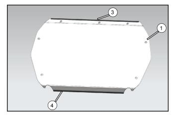
Installez la bande d'étanchéité A (3) et la bande d'étanchéité B (4) au pare-brise (2).
