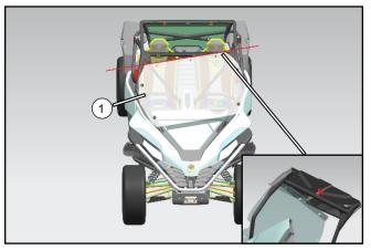
Inclinez un côté du pare-brise (1) et positionnez-le entre le toit supérieur et l'avant de la barre supérieure assemblée.
